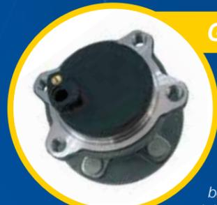
Diseño de doble brida con buje integrado para la fijación del rodamiento y disco y una brida secundaria para fijación de la suspensión.
